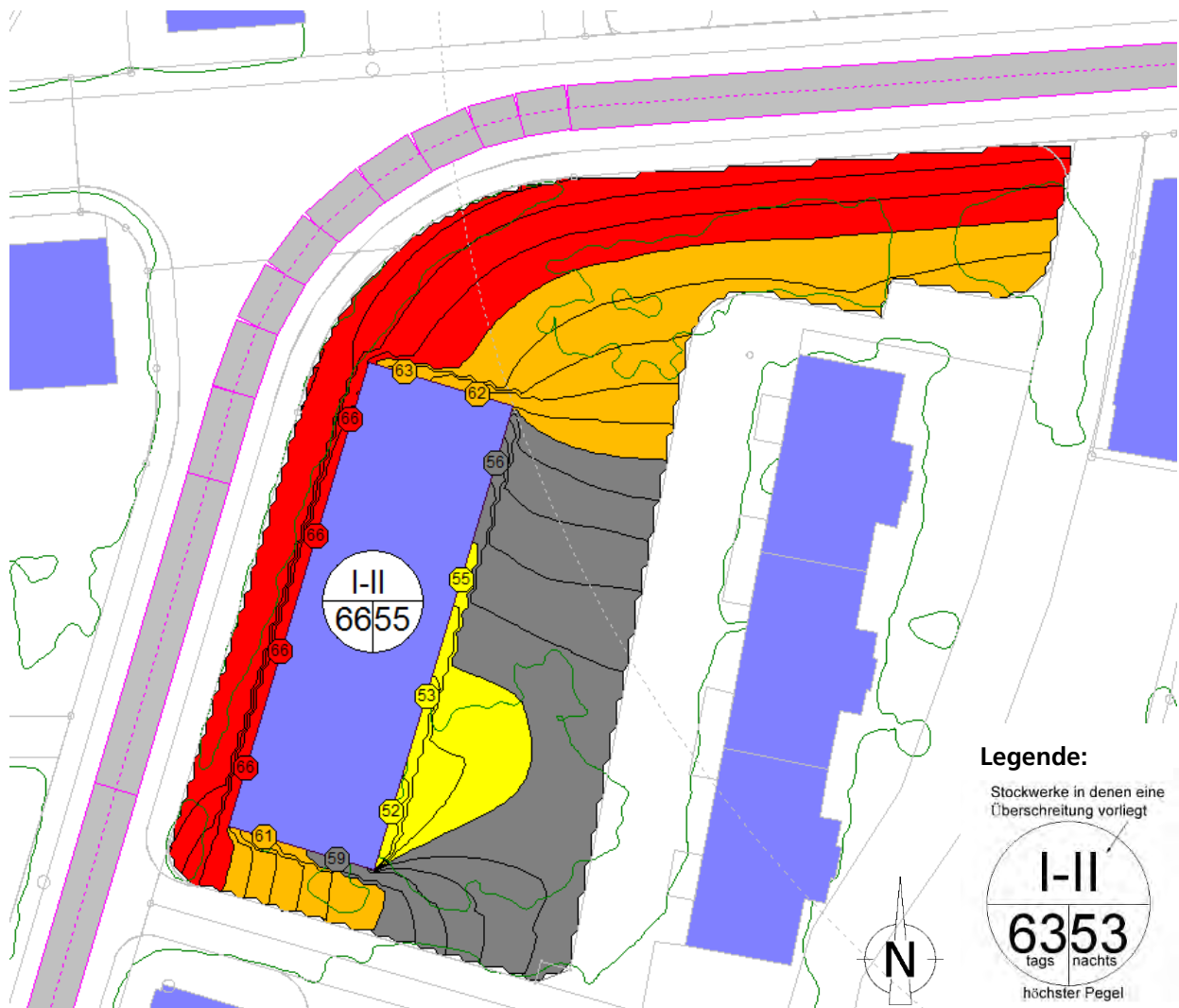
Abbildung 1: Berechnung der Lärmimmissionen am Tag (Hausbeurteilung) für den geplanten Gebäudekörper (Lärmberechnungsprogramm CadnaA Version 2020)
