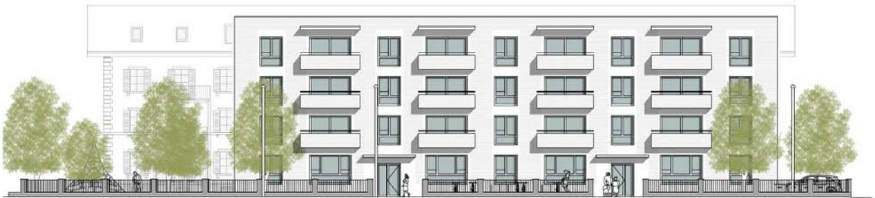
Es wird ein einfacher, längsrechteckiger Gebäudekörper auf einem Sockel und mit einem Flachdach vorgesehen. Insbesondere die Denkmalpflege lehnt die Anordnung eines Satteldaches ab; dies mit der Begründung, dass sich der Neubau nicht an den Bestand anbieten solle.
